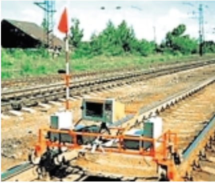
Рис. 2. Ручная дефектоскопическая тележка с АДС-02
