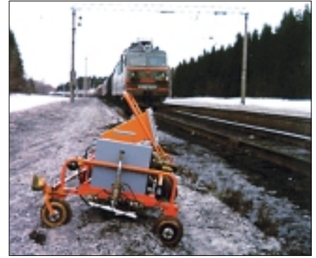
Рис. 3. Эвакуация дефектоскопической тележки при приближении поезда
